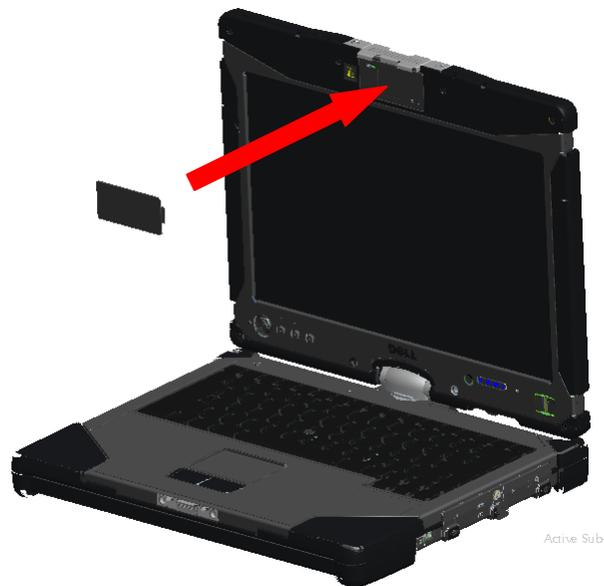
4. Verriegeln Sie das hot-Swap-Modul-Gerät an seiner Position, indem Sie die Verriegelung in die verriegelte Stellung bringen.
