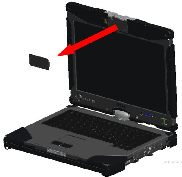
3. Führen Sie das hot-Swap-Modul ein (Kamera oder GPS). Stellen Sie sicher, dass das Gerät einwandfrei sitzt.
